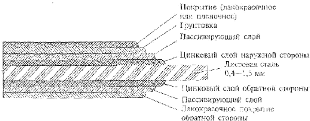
Рис. 1. Двойная система защиты стали от коррозии
