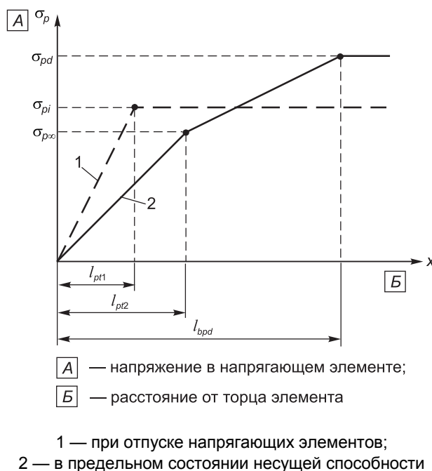
Рисунок 11.13 — Напряжения в зоне анкеровки предварительно натягиваемых напрягающих элементов
