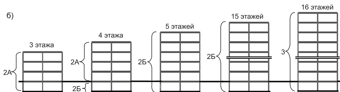
Рисунок Ж.3 — Нормирование классов по последствиям обрушения для зданий с подвальной частью: а — для отдельно стоящих зданий; б — для многоквартирных жилых зданий
