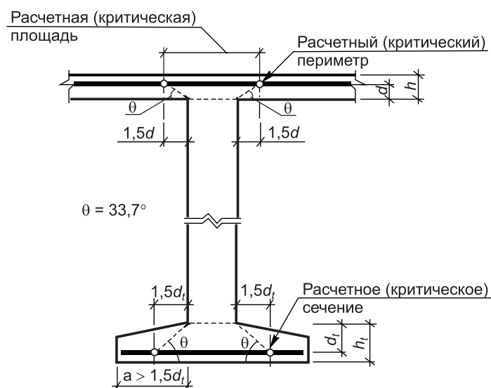
Рисунок 8.26 — Схема расчетной модели для определения прочности на местный срез (продавливание)
