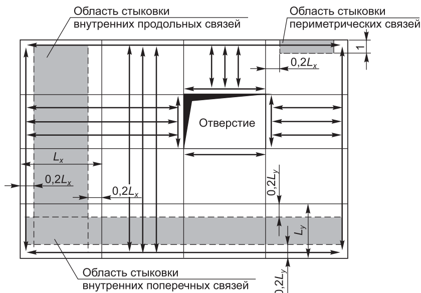
Рисунок Ж.9 — Схема размещения областей стыковки продольных, поперечных и периметрических внутренних связей
