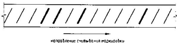
Рисунок 25 — Пример прокатной маркировки предприятия-изготовителя под номером 14
