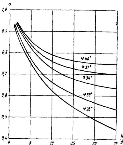
Рис. 41. График изменения коэффициента  $\alpha$  в зависимости от относительного заглубления оболочки в грунт  $\frac{h}{d}$  при различных значениях расчетного угла внутреннего трения грунта  $\varphi$
