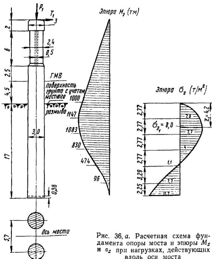
Рис. 36, а. Расчетная схема фундамента опоры моста и эпюры  $M_z$  и  $\sigma_z$  при нагрузках, действующих вдоль оси моста
