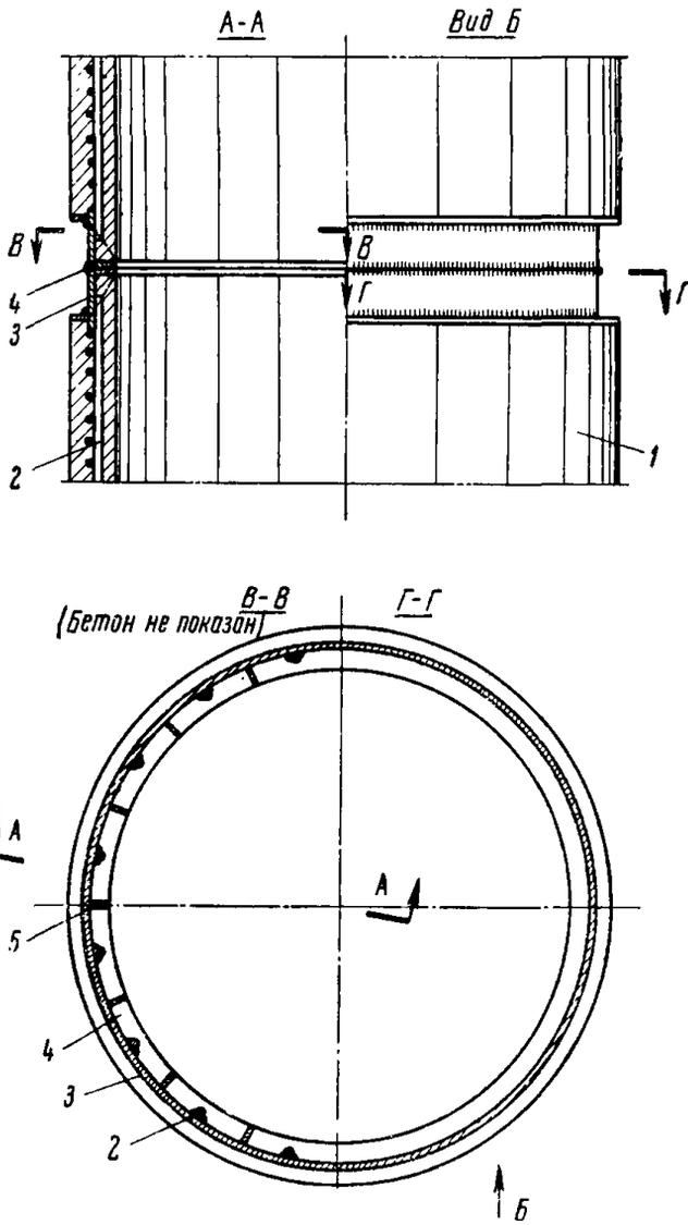
Рис. 7. Соединение секций оболочки сваркой
