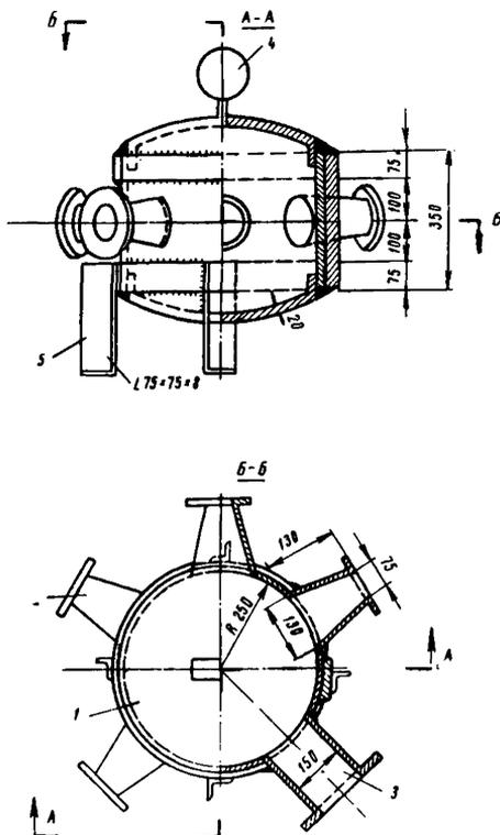
Рис. 70. Водораспределитель:
