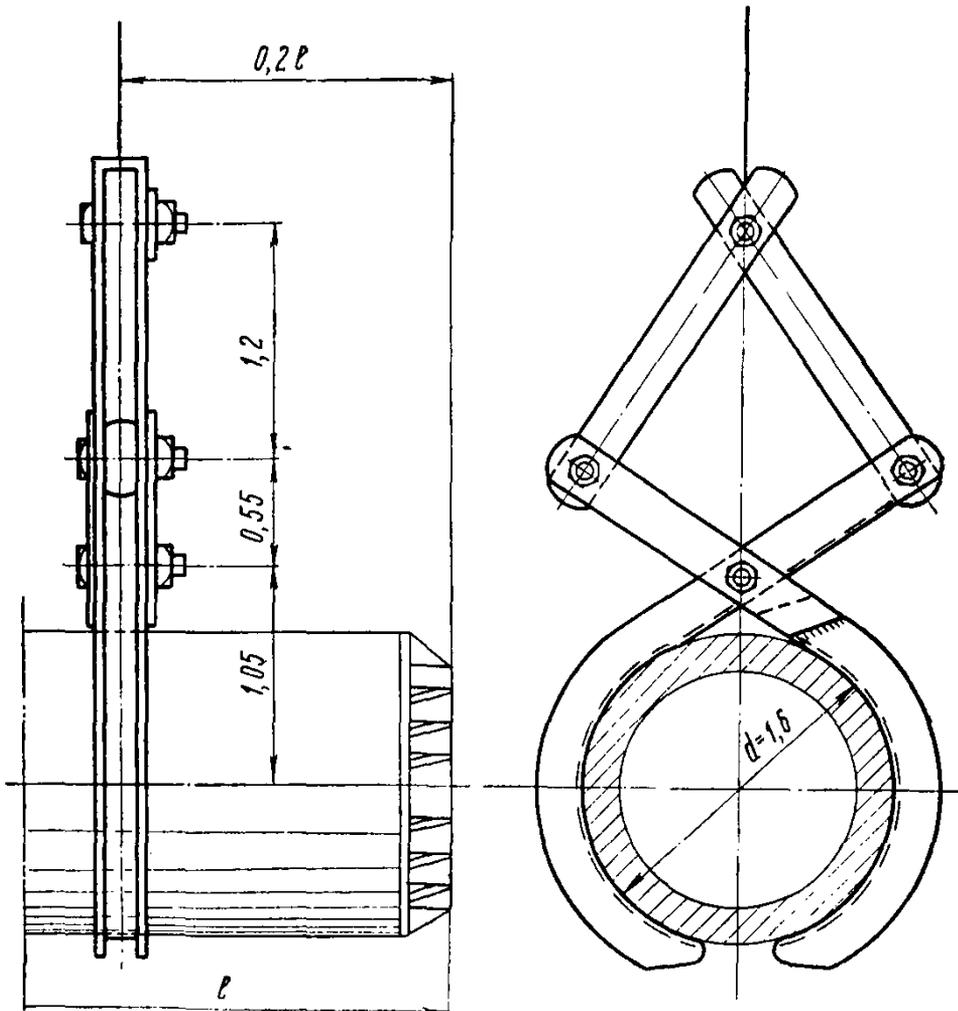
Рис. 56. Захват для оболочек диаметром 1,6 м
