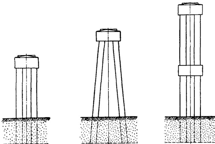
Рис. 2. Схемы опор из оболочек диаметром 0,4—0,8 м
