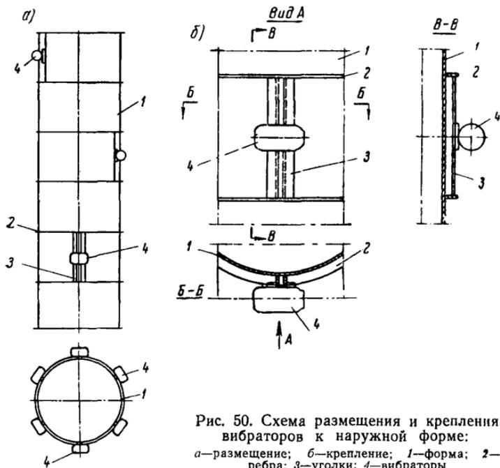
Рис. 50. Схема размещения и крепления вибраторов к наружной форме:
