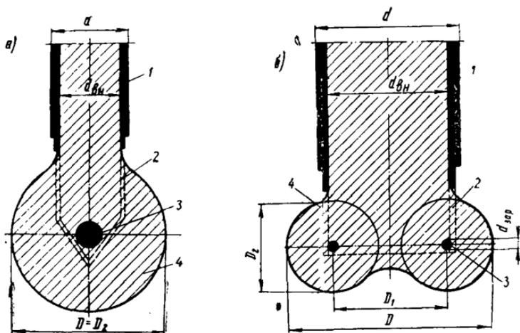
Рис. 71. Схема камуфлетных уширений:
