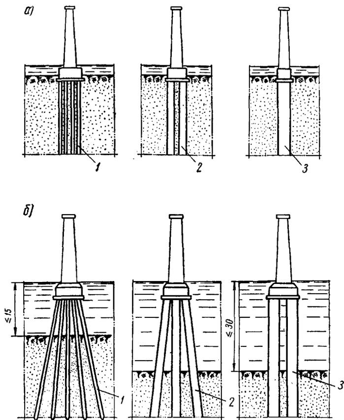
Рис. 1. Схемы фундаментов из оболочек различного диаметра:
