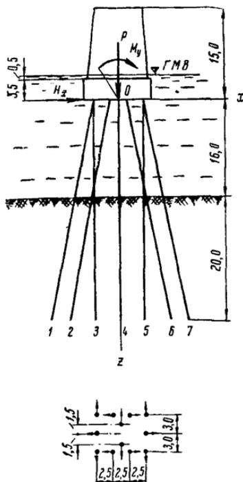
Рис. 38. Схема фундамента с наклонными оболочками
