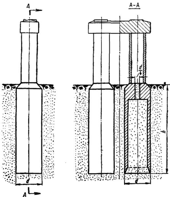
Рис. 4. Фундамент из оболочек с несущей диафрагмой
