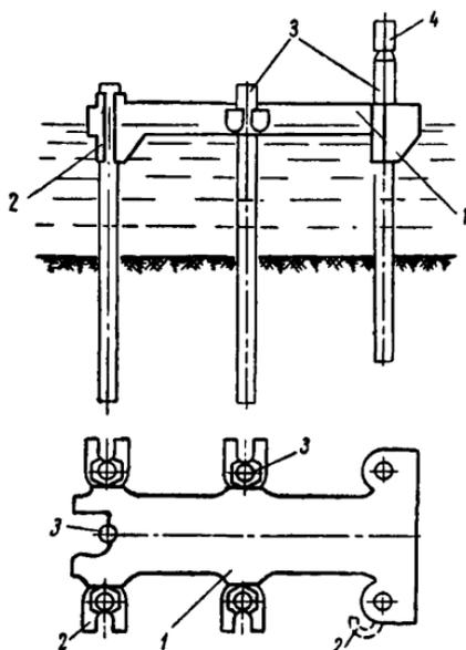
Рис. 61. Плавучий направляющий кондуктор:
