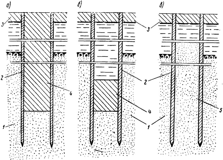
Рис. 13. Схемы заполнения полости погруженных в грунт оболочек:
