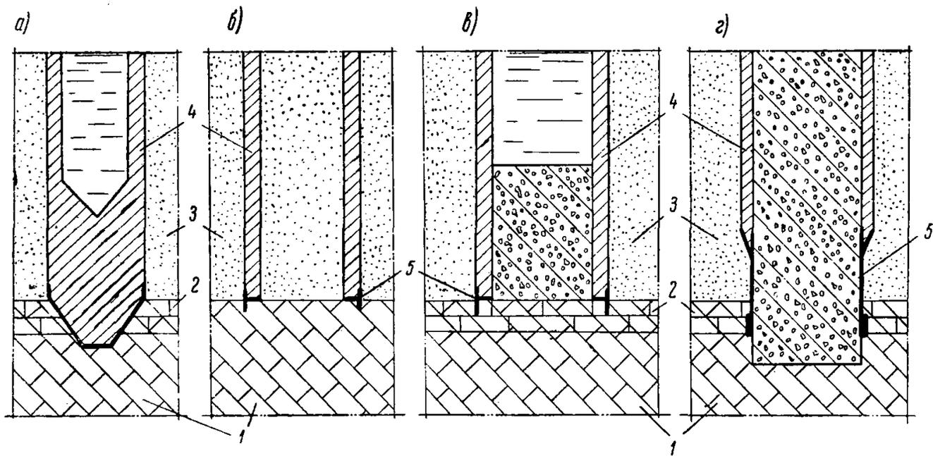
Рис. 15. Схема опирания оболочек на скальную породу:
