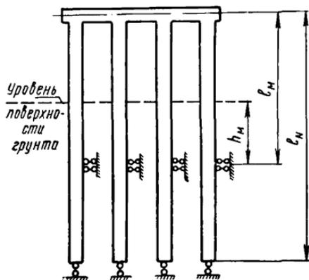
Рис. 33. Схема приближенного расчета фундаментов с гибкой плитой
