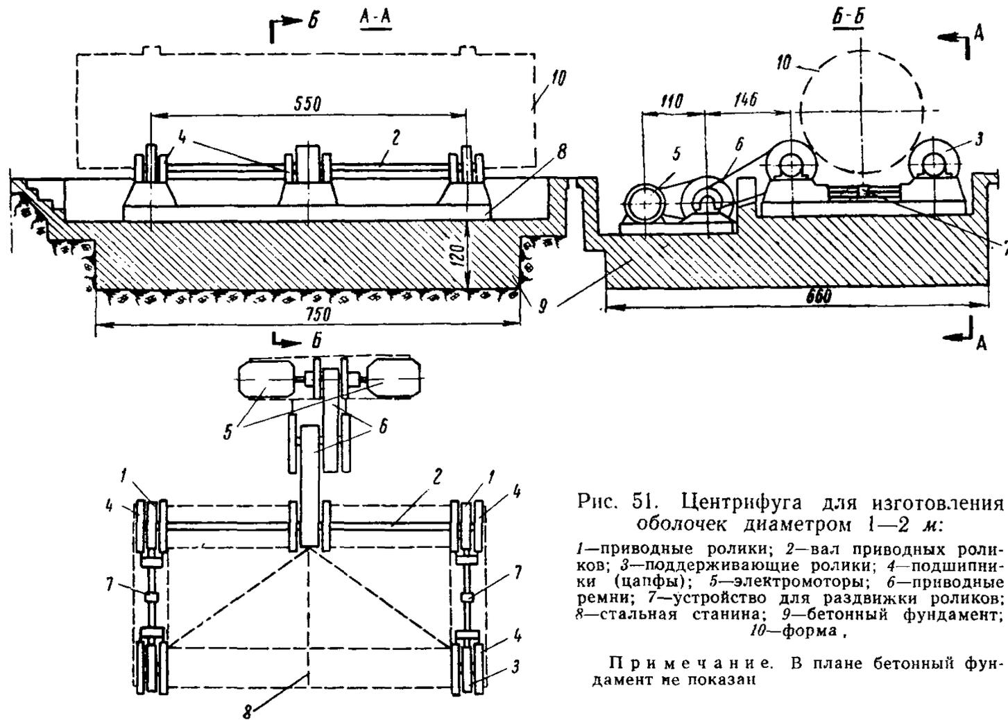
Рис. 51. Центрифуга для изготовления оболочек диаметром 1—2 м:
