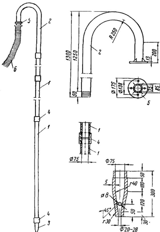
Рис. 52. Подмывная трубка:
