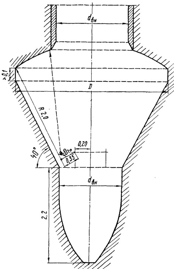
Рис. 14. Контур уширения в основании оболочки, разбираемого станком ЦНИИСа
