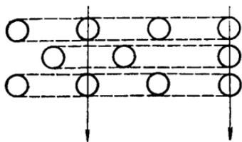
Рис. 25. Схема для установления коэффициента  $k$  при шахматном порядке расположения столбов
