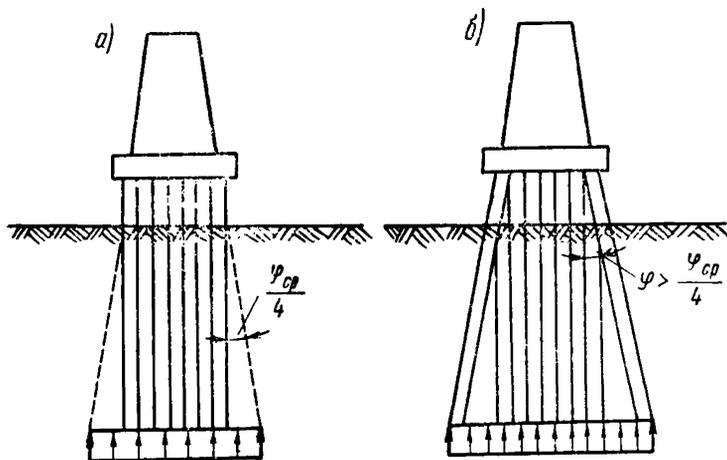
Рис. 19. Схемы распределения давления в грунте:
