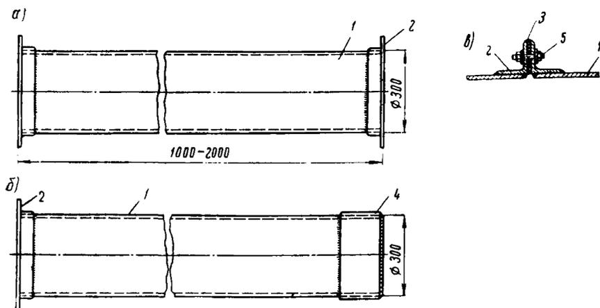
Рис. 79. Звенья (секции) бетонолитной трубы:
