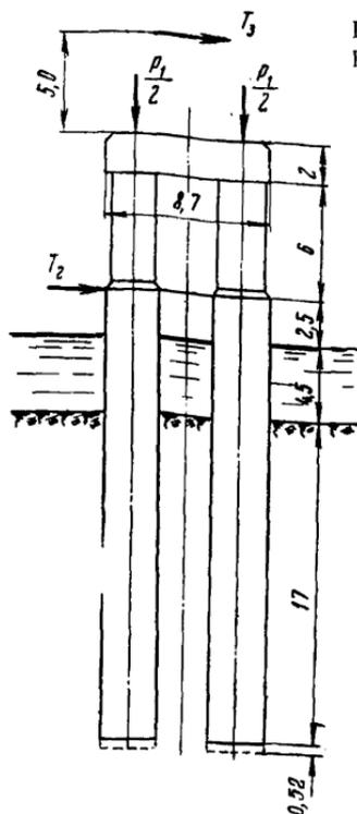
Рис. 36, б. Расчетная схема фундамента опоры моста и эпюры  $M_z$  и  $\sigma_z$  при нагрузках, действующих поперек оси моста
