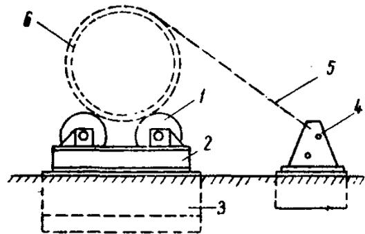
Рис. 53. Стенд для стыкования секций оболочки:
