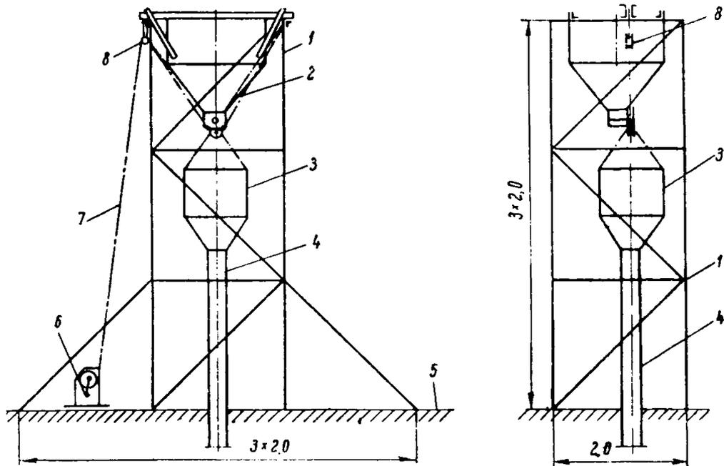
Рис. 82. Подъемник из конструкций УИКМ:
