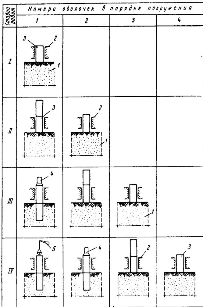
Рис. 64. Схема поточного погружения оболочек:
