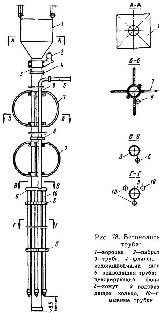
Рис. 78. Бетонлитная труба:
