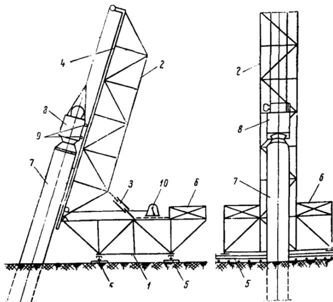
Рис. 58. Направляющая стрела в виде копра:
