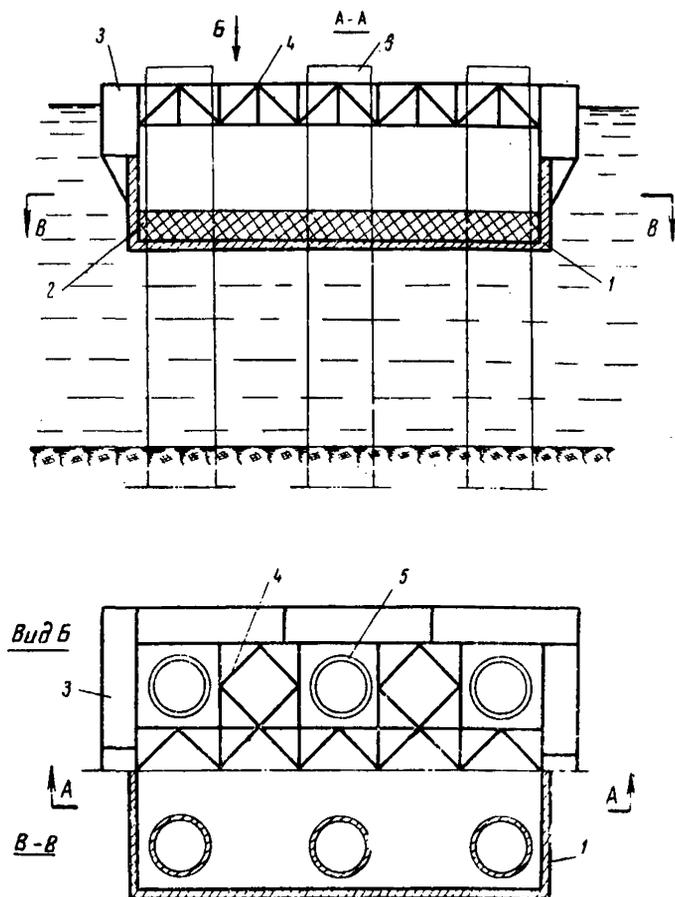
Рис. 90. Ограждение из железобетонного ящика (или железобетонных щитов):
