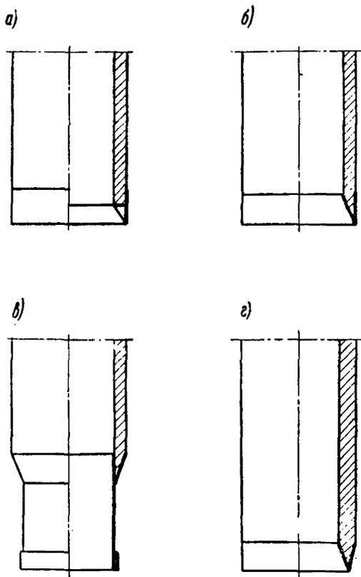
Рис. 12. Наконечники открытой конструкции (ножи) для оболочек:
