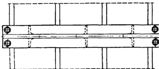
Рис. 86. Инвентарные хомуты для обеспечения неизменяемости сплотов:
