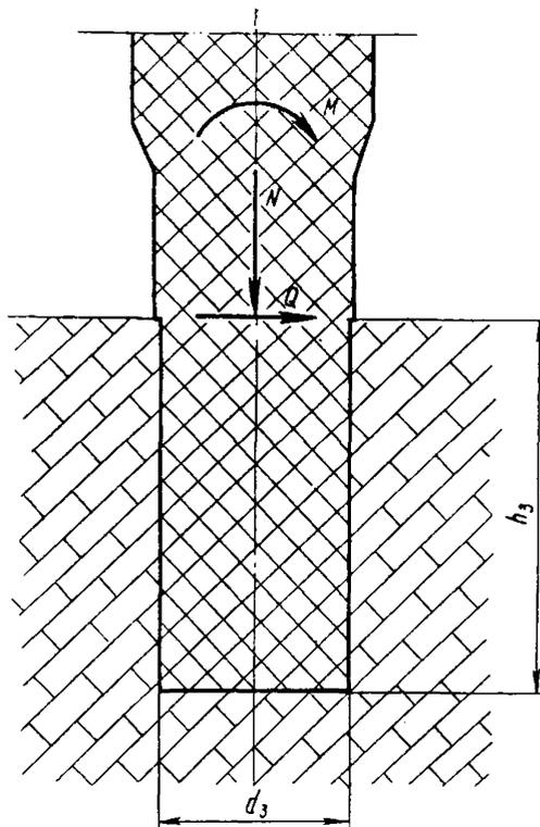
Рис. 43. Схема усилий, действующих на столб, заделанный в скальную породу
