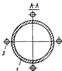
Рис. 66. Схема закрепления подмывных трубок к вертикальной оболочке:
