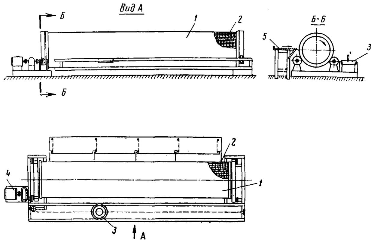
Рис. 47. Приводной станок для сборки арматурных каркасов:
