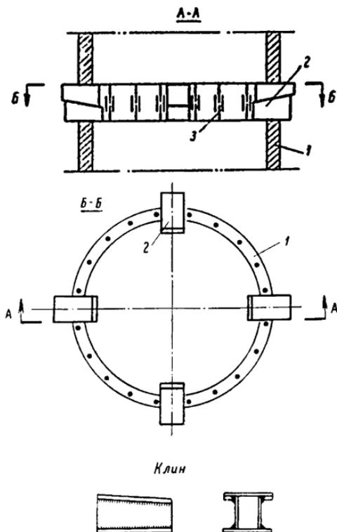
Рис. 54. Схема установки клиньев при сварке выпусков арматуры стыкуемых секций:
