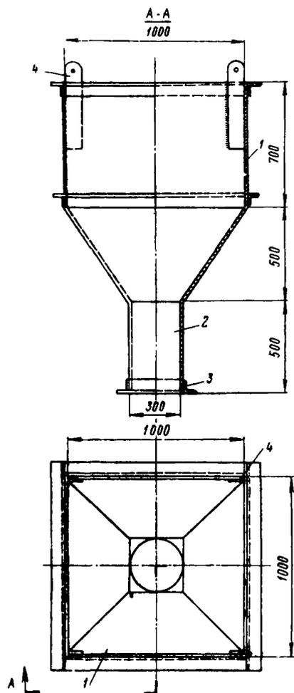
Рис. 80. Воронка бетонолитной трубы:
