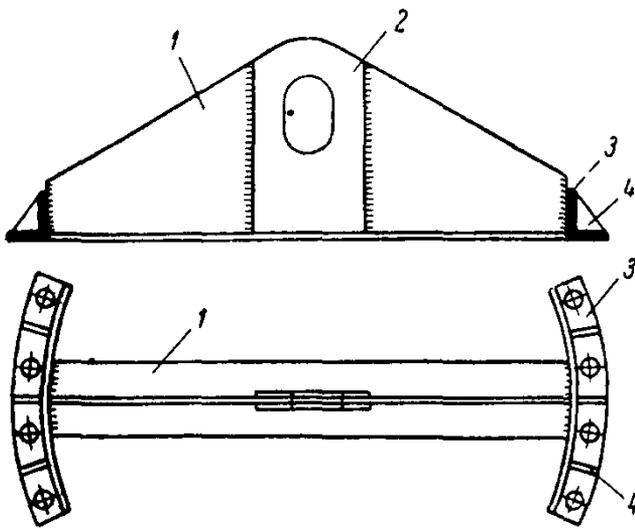
Рис. 55. Строповочное устройство:
