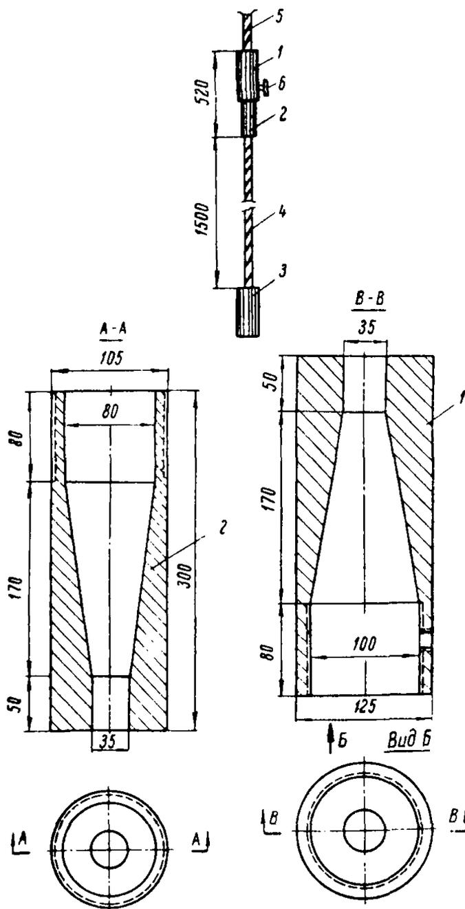
Рис. 75. Стыкование троса на муфтах:
