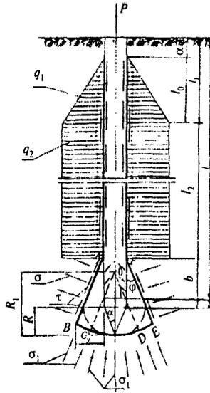
**Рисунок Е.1 — Расчетная схема**
