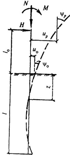
*Рисунок В.1 — Схема нагрузок на сваю*
